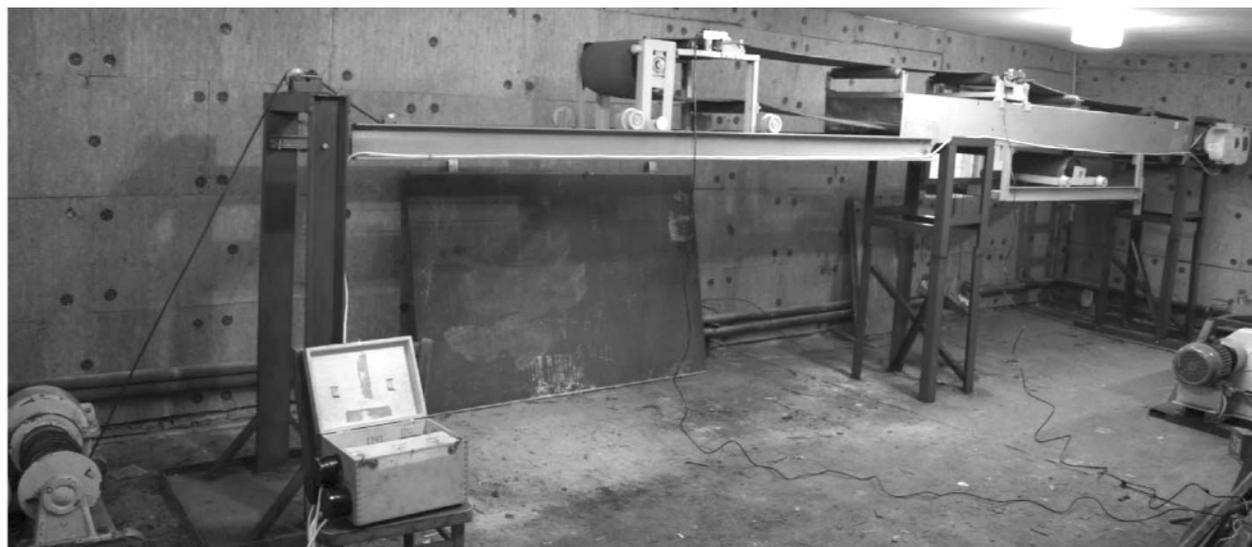
*Рис. 3. Общий вид экспериментального конвейера для исследования нагруженности ленты возникающей во время изменения длины транспортирования*
