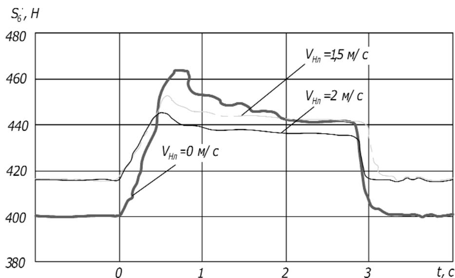
*Рис. 4. Графики изменения нагруженности ленты на барабане передвижной станции экспериментального конвейера для различной скорости движения ленты, создаваемой приводом конвейера, в зависимости от времени изменения длины транспортирования при весе натяжного устройства  $G_{Н.У.} = 400Н$*
