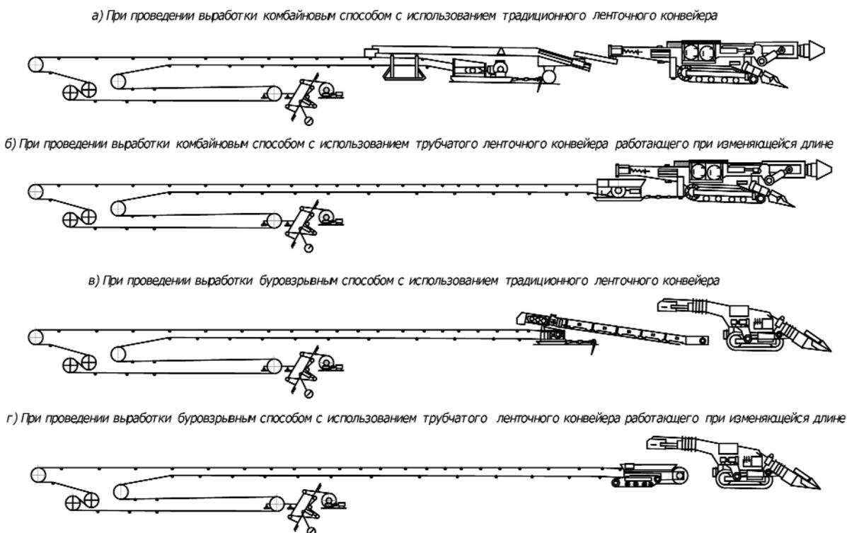
**Рис. 1.** Конструктивно-технологическая схема проведения тоннелей
