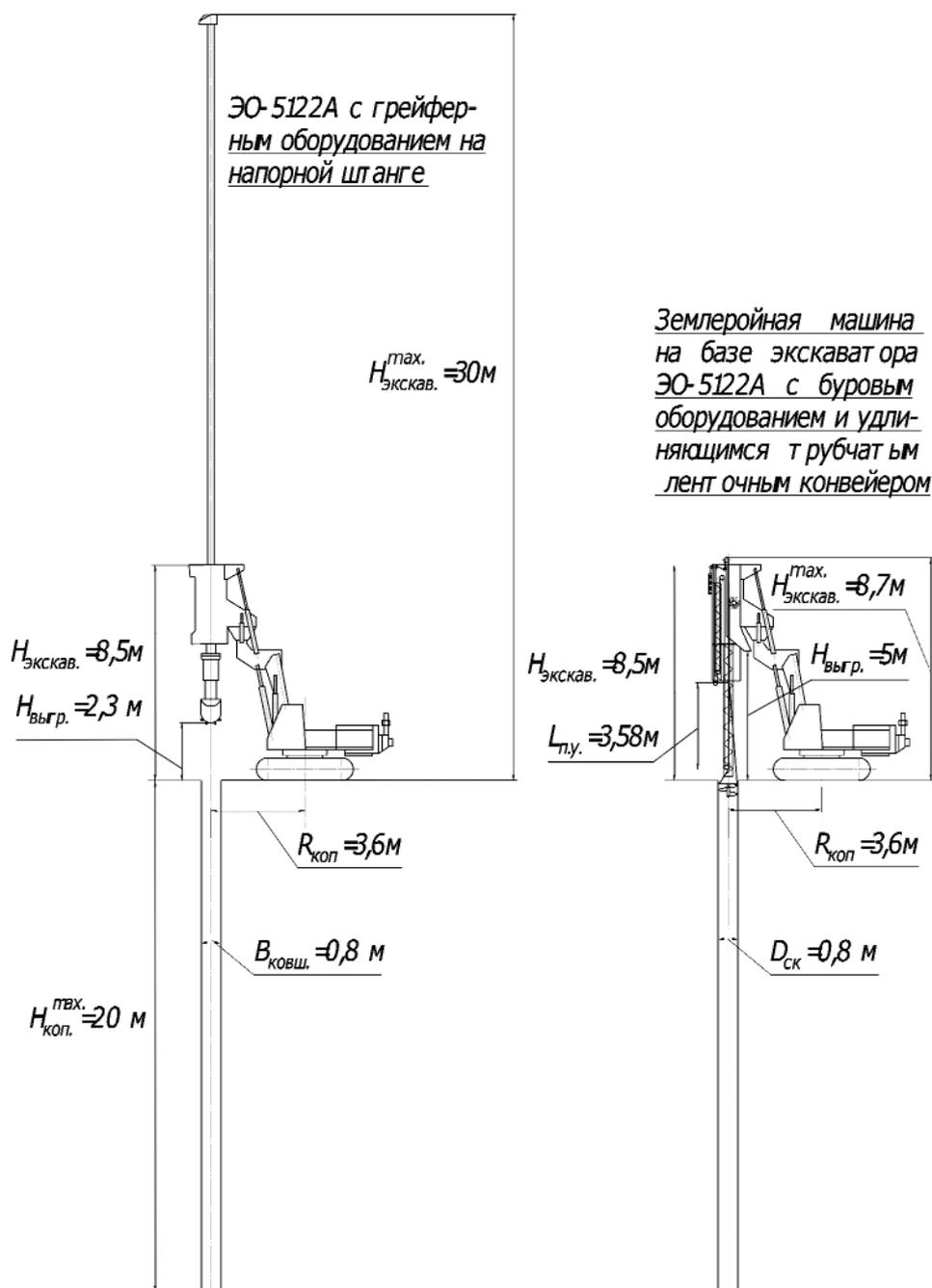
**Рис. 2.** Конструктивно-параметрические схемы землеройных машин для бурения скважин
